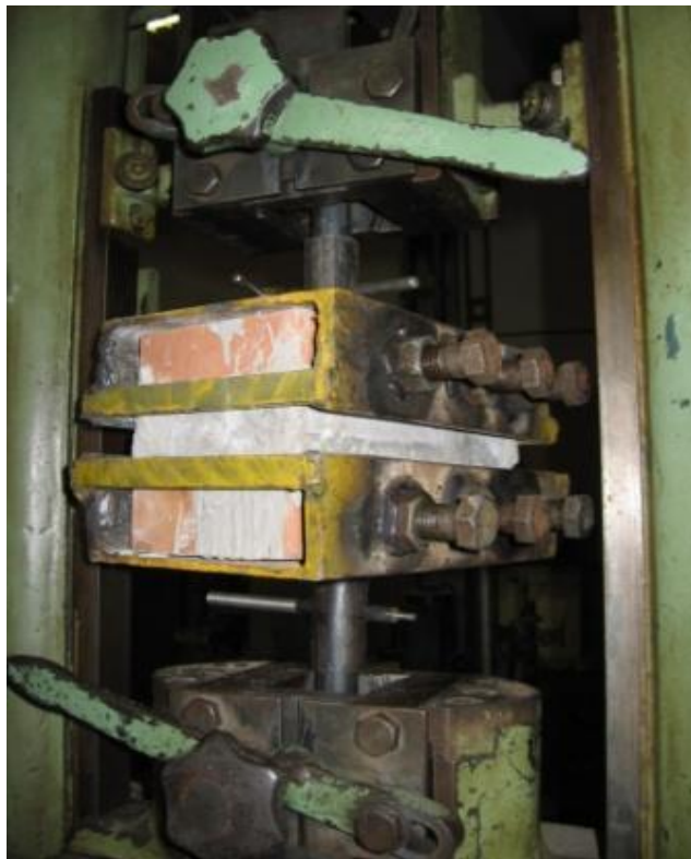
Рисунок 15. Определение прочности сцепления инъекционного раствора с кирпичом
