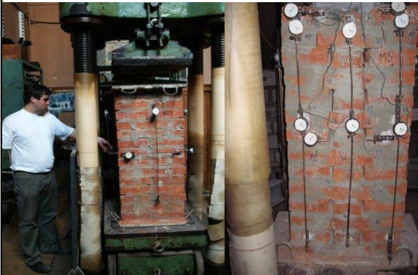
Рисунок 13. Определение несущей способности усиленной кладки
