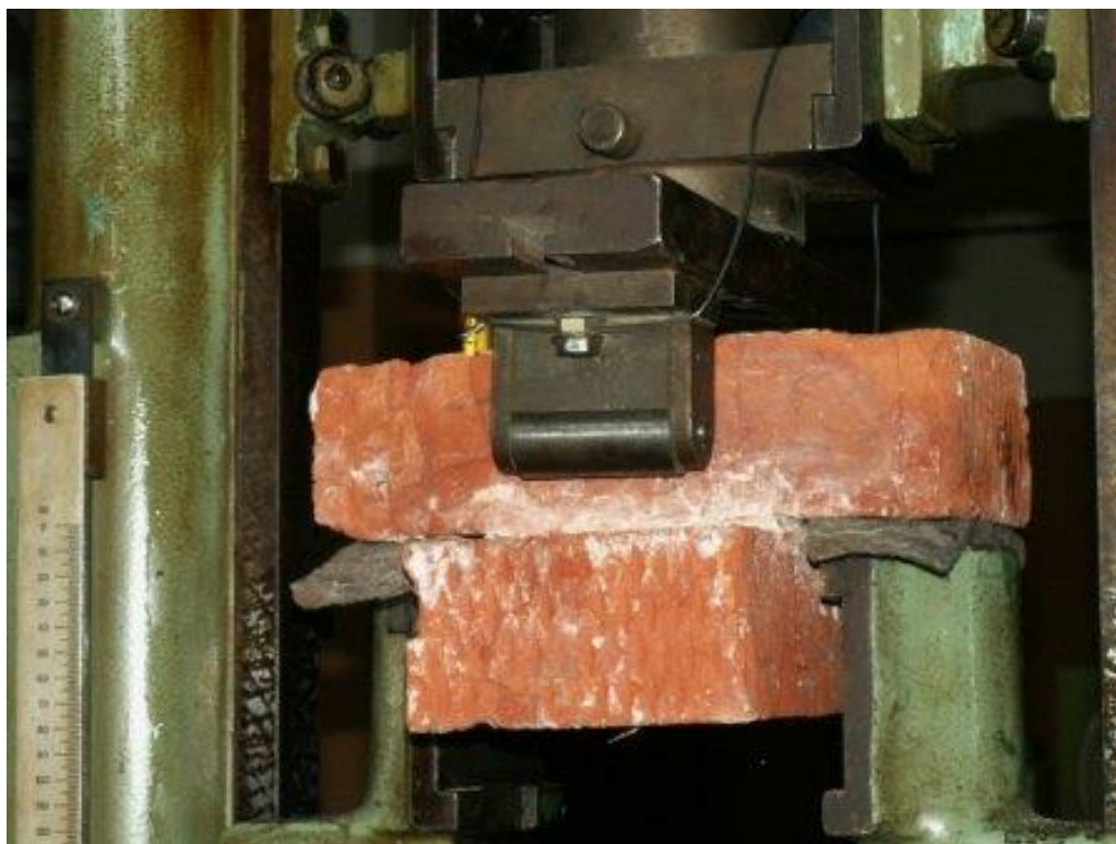
Рисунок 14. Определение сцепления инъекционного раствора с кирпичом
