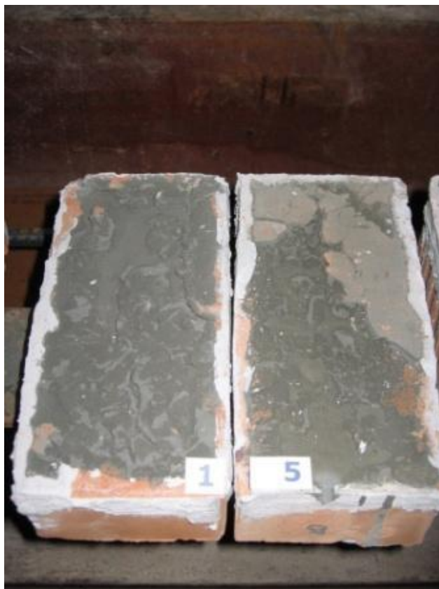
Рисунок 16. Образцы после испытания на разрыв
