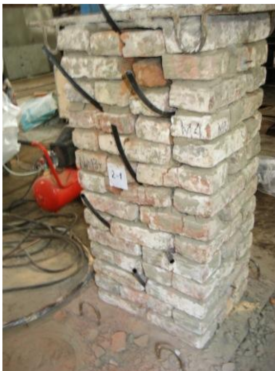
Рисунок 18. Подготавливаемый для усиления инъекцией образец из исторического кирпича
