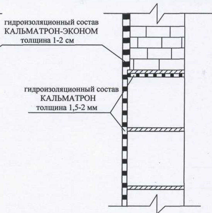
4. Нанесение гидроизоляционного слоя
