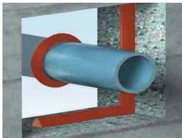
Установка шнура УЛЬТРАПЛАТ на сопрягаемых фундаментных конструкциях
